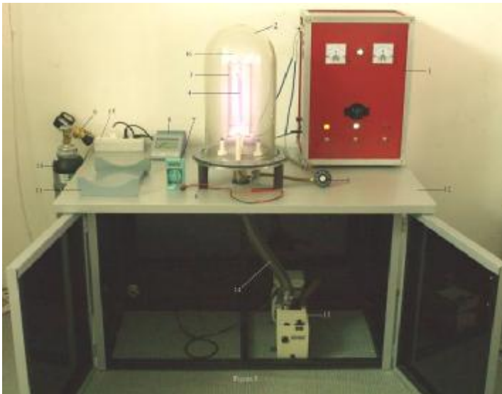
Figura 7: Instalația completă de tratare în plasmă a documentelor papetare:
